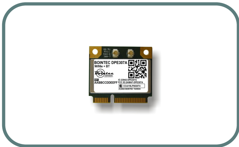
802.11abgn/ac/ax+BT5.2 ,2T2R, miniPCIe module
